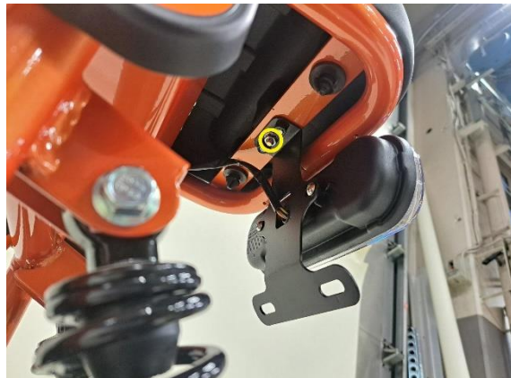
Irrota istuimen kiinnitysmutteri (kiintoavain 10 mm).
